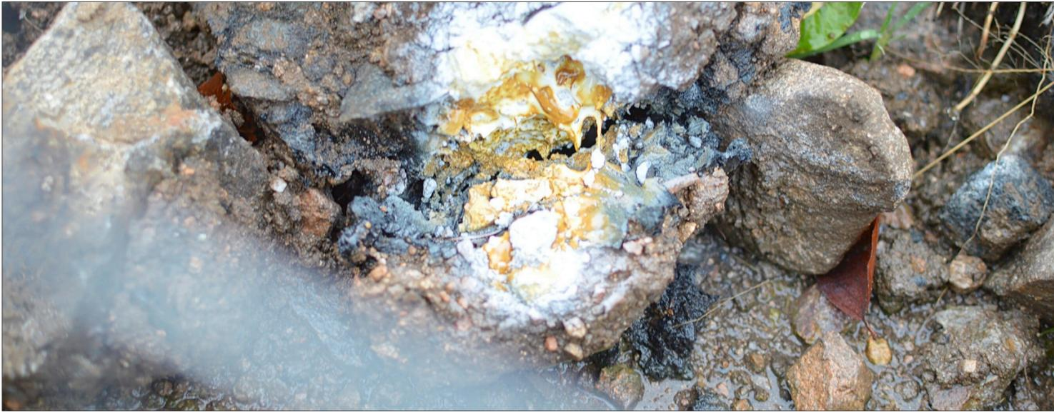
Bei einer erhöhten Konzentration von PAK verfärbt sich das Indikator-Spray gelb-braun.
